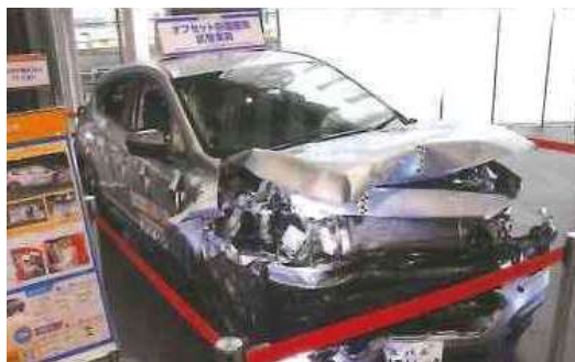
ファイブスター大賞を受賞したスバル・クロストレック（実車とオフセット前面衝突試験後の車両）
