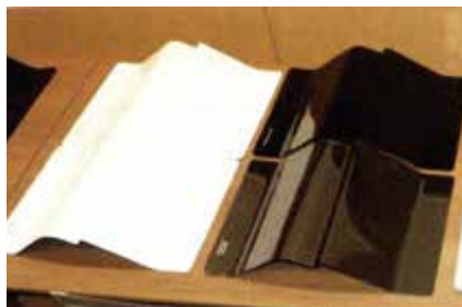
日射反射率を考慮したホワイトとブラック。赤外線を反射する「IRブラック」と呼ばれる黒顔料を使用している
