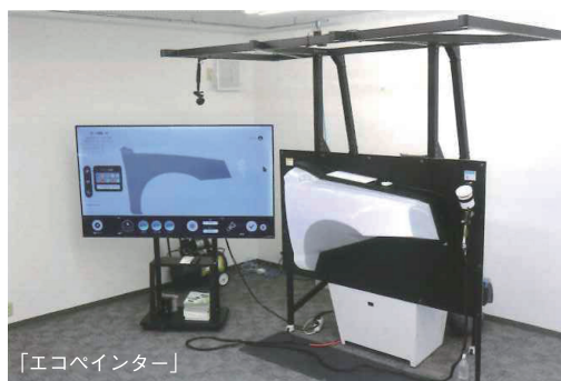
塗装動作を数値化して採点するだけでなく、スプレーガンの軌跡なども可視化する
