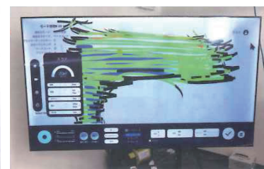
塗装動作を数値化して採点するだけでなく、スプレーガンの軌跡なども可視化する
