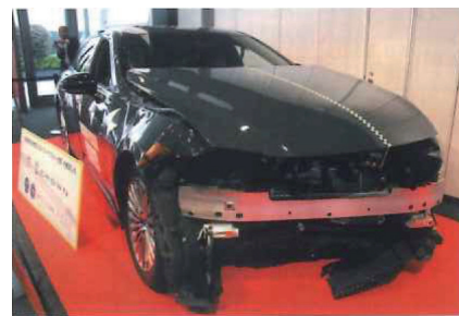
「ファイブスター大賞」を受賞したトヨタ・クラウン(セダン)のオフセット前面衝突試験後の車両
