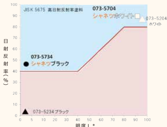
各種塗料の明度と赤外波長域の日射反射率
