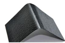
塗布した試験板を曲げても割れや剥がれなく強力な密着力と柔軟性を実現しました
