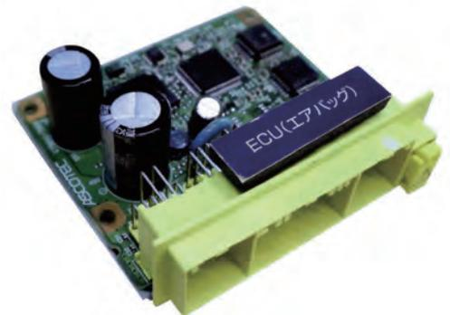
EDRデータはエアバッグコントロールユニットに設置されることが多い。一部の車両ではエンジンコントロールユニットの場合もある
