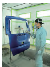
最新鋭の塗装ブースになり作業環境が向上。ブースの横には、大型の吊り下げ式カーボンヒーターが設置されている
