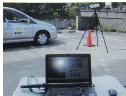
ナンバー自動読み取り装置。カメラで撮影したナンバープレートから車検切れ車両を捕捉し、モニター上に情報を表示する
