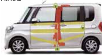
左側の前後ドアに内蔵される超高張力鋼板
